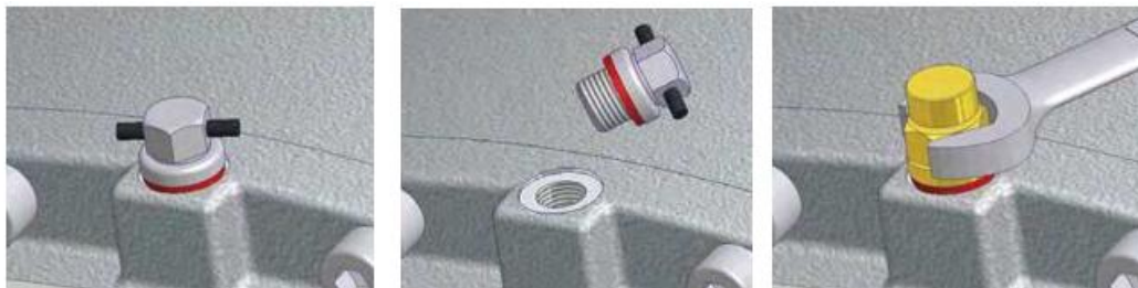
Zámena klasickej odvzdušňovacej skrutky s poistnou gumičkou za pribalenú tlakovú odvzdušňovaciu skrutku
